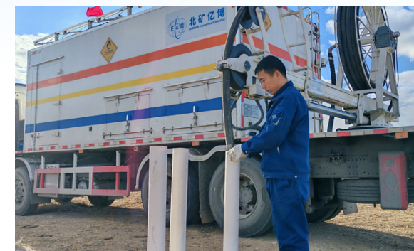
具有图像智能识别、高精度定位、智能寻孔等功能的BCJ-3S现场混装乳化炸药车，成功实现智能化无人化装药作业
