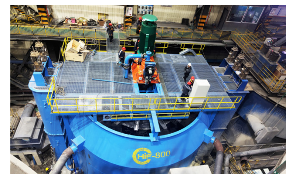
世界最大规格浮选机 HIF-800m³ 浮选机在普朗铜矿成功投入运行
